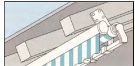
Unkompliziert: die Dachsparrenbefestigung der >BASIC SUN<
